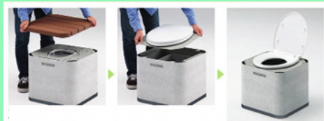
下水道と直結して災害時の仮設トイレになります。ベンチ座面を外し便座部分を取り付けて使用します。
