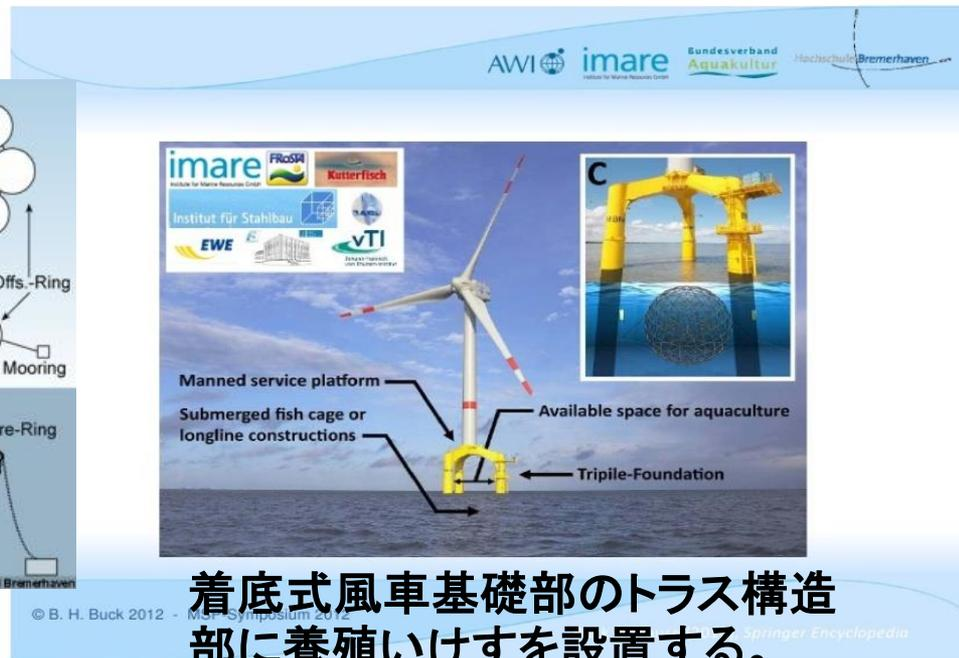
着底式風車基礎部のトラス構造部に養殖いけすを設置する。
