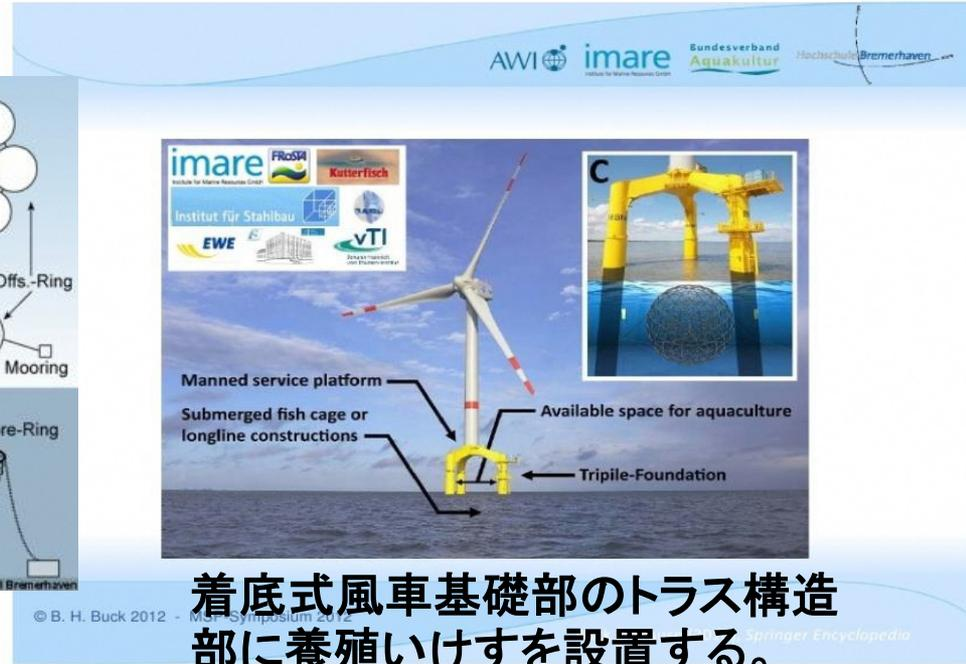
着底式風車基礎部のトラス構造部に養殖いけすを設置する。
