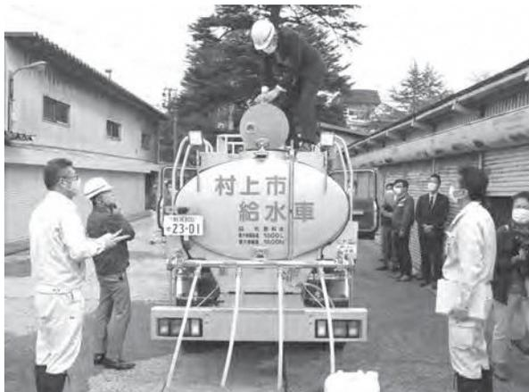
市に3台目の給水タンク車が導入されました。この給水タンク車は「いすゞエルフ」をベースに1800リットルの水を積載できるタンクが設置され、小口の給水のほか、高所への給水を可能にした加圧ポンプも搭載されています。また、さまざまな気象条件を想定し、駆動を四輪駆動車としたほか、LEDの作業灯も装備されています。車両重量を5トン以下にしたため普通自動車免許（平成29年改正前制度の対応）で運転ができ、汎用性のある仕様になっています。
