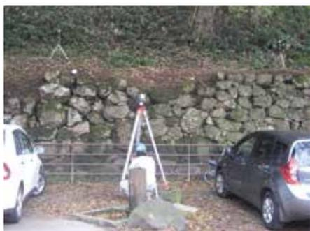
石垣移動量調査（3Dレーザー測量）
