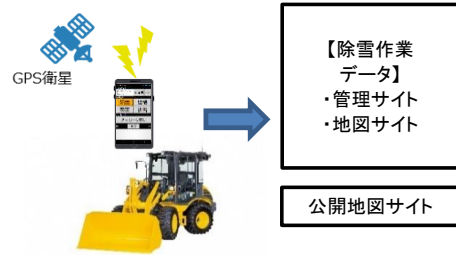
GPS端末を除雪車に設置
