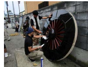
図 村上まつりの屋台車輪の点検・修理の様子
