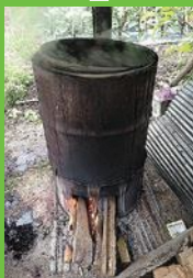
【5】しな煮 繊維以外を溶かすため、樹皮に灰をまぶしドラム缶で煮る
