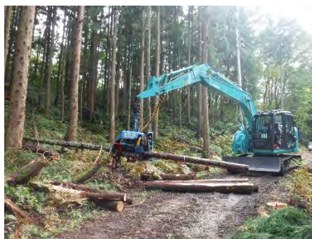
高性能林業機械ハーベスタによる玉切り
