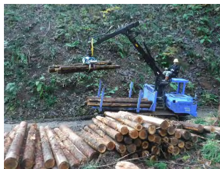
高性能林業機械フォワーダによる集材
