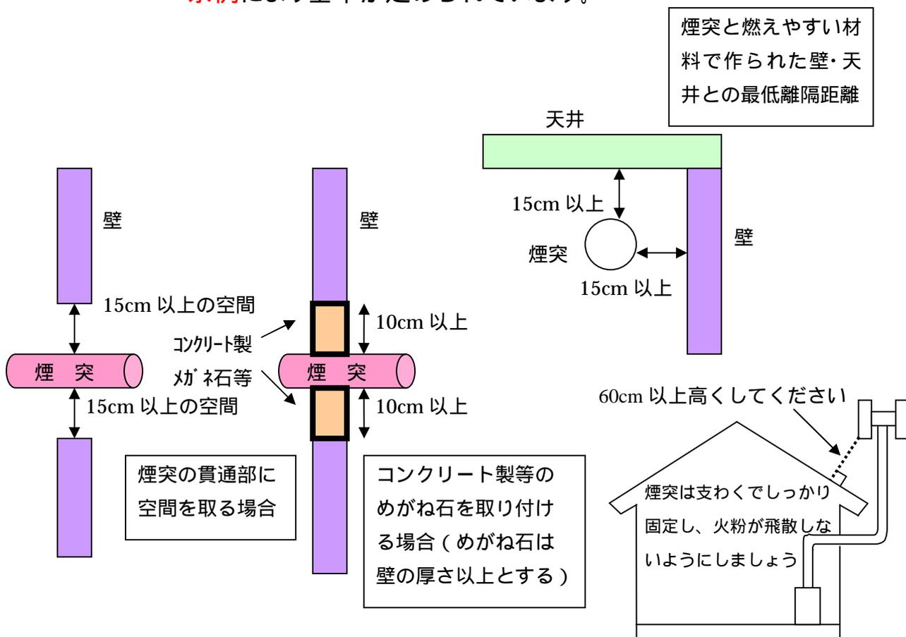
薪ストーブを室内に設置する場合も内装を不燃化していない場合左図のように壁、天井面からの距離をとる必要があります。
